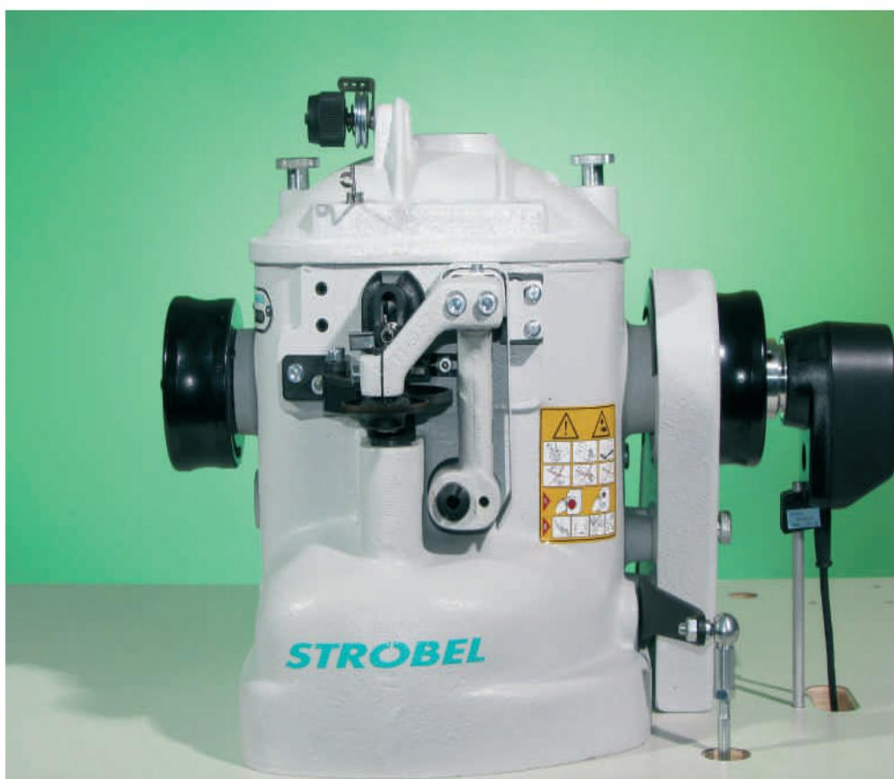
Macchina da cucire a piattelli, per lavorazione sottopiede, con separatore, motore Efka. CEE.
